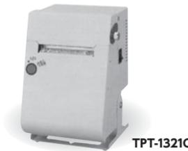
TPT-1321Cはオートカット付ラインサーマル方式のプリンタです。ANK160文字を内蔵し、JIS第一、第二水準の漢字が印字できる多機能プリンタです。発券に必要な大文字(0~9、A~Zの36文字)フォントも内蔵し、バーコード印字ができたまたシフトJISコードによる漢字指定もできます。設置方法はタテ型、ヨコ型の据置、同しく、タテ型、ヨコ型の壁かけが選べます。
